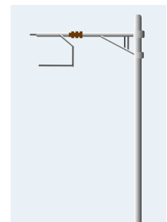
Fahrleitung, z.B. SBB 15 kV
