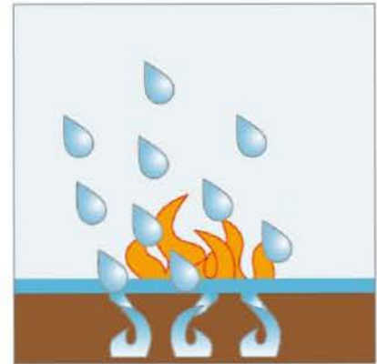
Mit Netzmittel: Das Wasser kann sich ausbreiten und in das Brandgut eindringen
