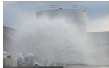
Niederschlagen von Gasen und Dämpfen mit einem Hydroschild
