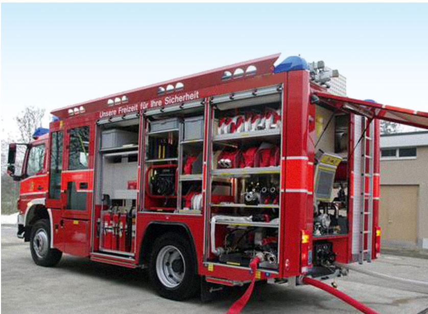
Tanklöschfahrzeug (TLF), z.B. 2'400 l
