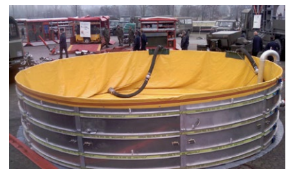
Auffangbehälter aus Aluminiumelementen, z.B. 50'000 l
