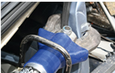
Hydraulische Schere im 90°-Winkel
