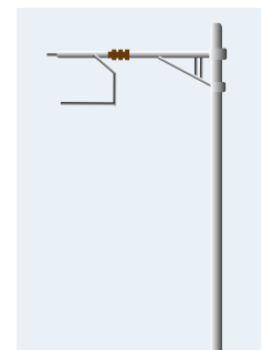
Fahrleitung, z.B. SBB 15 kV
