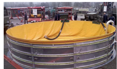
Auffangbehälter aus Aluminiumelementen, z.B. 50000 l
