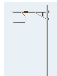
Fahrleitung z.B. SBB 15 kV
